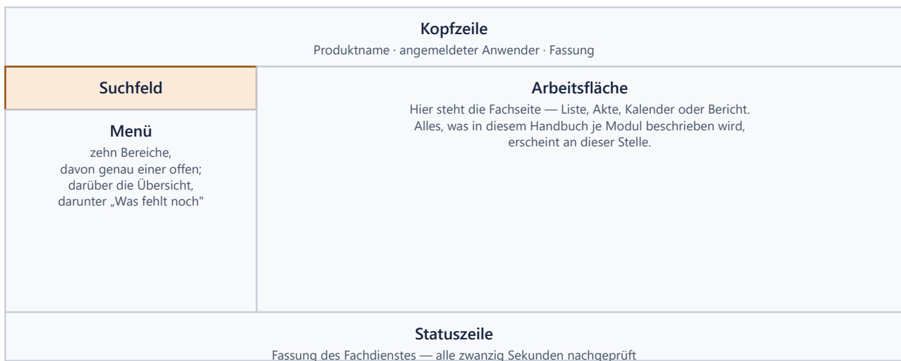
Abbildung 3 — Der Aufbau des Bildschirms. Kopfzeile, Menü, Arbeitsfläche und Statuszeile stehen auf jeder Seite an derselben Stelle.
