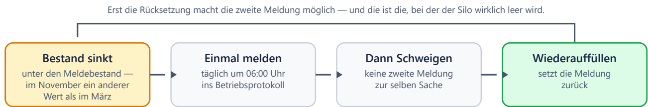
Abbildung 18 — Der Meldebestand meldet sich einmal und schweigt dann. Zurückgesetzt wird er beim Auffüllen.
